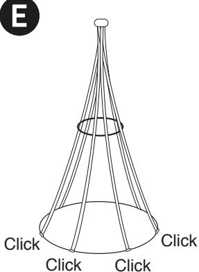
**SE** Fäst den stora ringen på de vertikala banden innanför ringkrokarna. Se till att de vertikala banden dras i en rak linje mellan den övre lilla ringen och den nedre större ringen.
