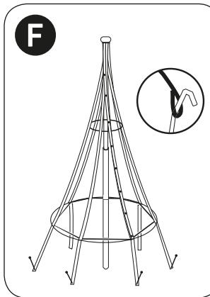
**SE** Dra åt de vertikala banden genom **7** att dra de elastiska öglorna neråt och förankra dem i mark med de medföljande markstiftarna. Hissa upp trädet än en gång för att kontrollera att systemet är tätt och utan lösa remmar. Lås hissrepdet.
