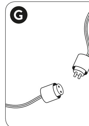
**SE** Anslut de små kontakterna som **8** hänger från banden till huvudtransformatorn. Dra åt varje kontakt ordentligt och täck transformatorn. Ditt träd är klart att användas!
