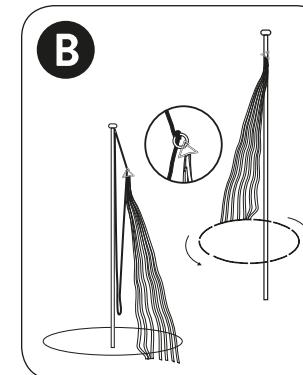
**SE** Fäst triangelhaken i metall på flaggstängens hissanordning och se till att den böjda sidan av triangelkroken sitter infälld mot stången. Hissa hela Fairybell®-systemet uppåt tills du lätt kan nå den förmonterade glasfiberpinnen. Kontrollera att de vertikala
