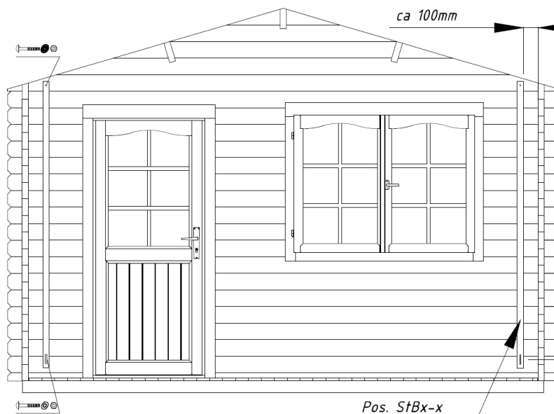
Montering av stormavstivere:
